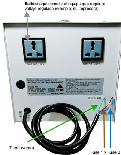
Salida: aqui conecte el equipo que requiere voltaje regulado (ejemplo: su impresora)
